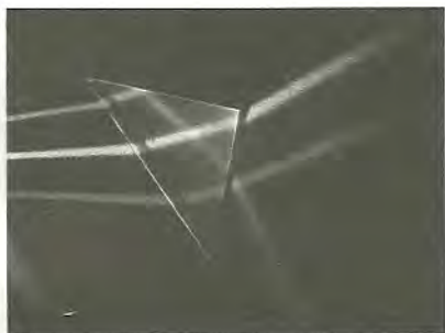
FIGURA 23.21 Um dos três feixes de laser sofre reflexão interna total.
