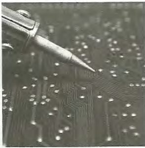
Quando dois objetos estão em contato direto, como o chumbo da solda e a placa deste circuito elétrico, o calor é transferido por condução .
