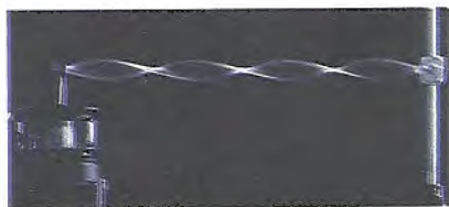
FIGURA 21.12 Fotografia tirada com grande tempo de exposição da onda estacionária em uma corda esticada correspondente a m = 4 .
