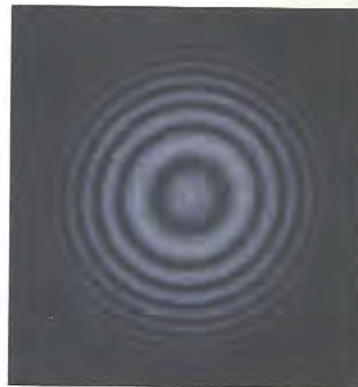
FIGURA 22.21 Fotografia das franjas de interferência produzidas por um interferômetro de Michelson.
