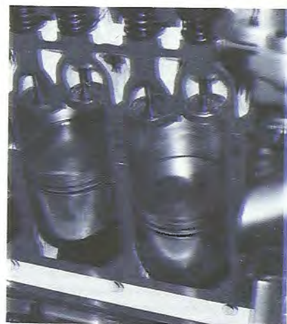
Os pistões do motor de um carro realizam trabalho sobre a mistura ar-combustível ao comprimi-la.
