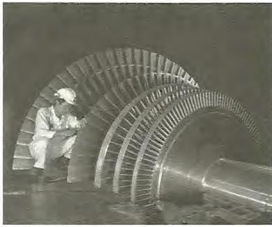
A turbina a vapor de uma usina elétrica moderna é um dispositivo enorme. O vapor em expansão realiza trabalho ao girar a turbina.
