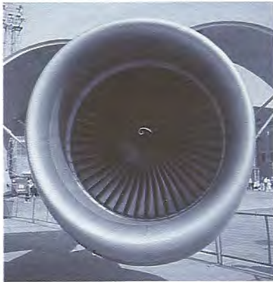
O motor de um avião a jato usa um ciclo de Brayton modificado.
