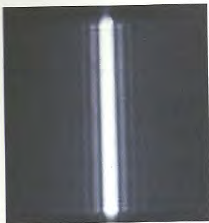
O máximo central deste padrão de difração de fenda simples parece branco porque a foto foi obtida com superexposição. A largura do máximo central é evidente.
