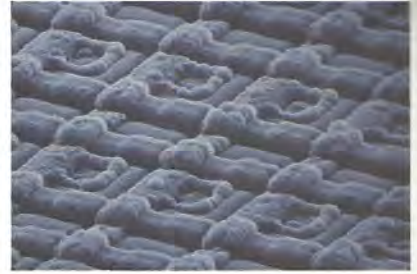
O tamanho característico dos elementos de um circuito integrado é limitado pela difração da luz.
