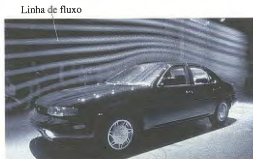
FIGURA 15.27 O fluxo de ar laminar em torno de um carro em um túnel de vento fica visível com a fumaça. Cada trilha de fumaça representa uma linha de fluxo
