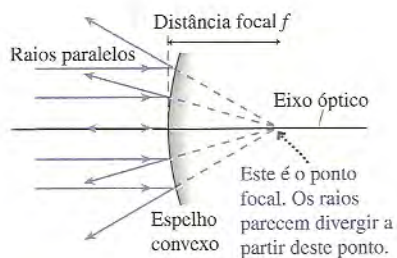
FIGURA 23.53 Ponto focal e distância focal de um espelho convexo.
