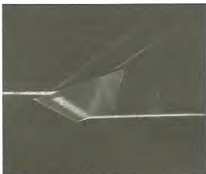
FIGURA 23.14 O feixe de um laser é refratado por um prisma de vidro. Pode-se ver também duas reflexões fracas saindo da superfície superior do prisma.
