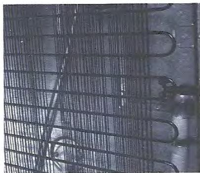
Esta serpentina de resfriamento constitui o trocador de calor a alta temperatura de um refrigerador. A energia térmica é transferida do gás quente, dentro da serpentina, para o ar ambiente, mais frio.
