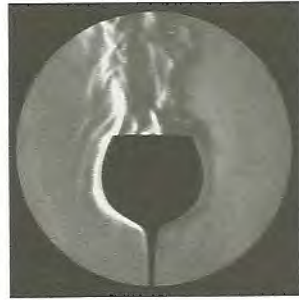
As correntes de ar próximas a um copo com água quente sobem, levando energia térmica junto consigo em um processo conhecido por convecção .
