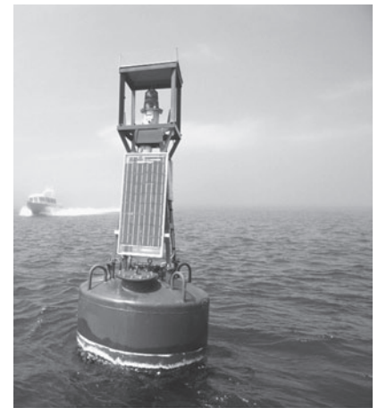
Este painel fotovoltaico transforma energia solar em energia elétrica.
