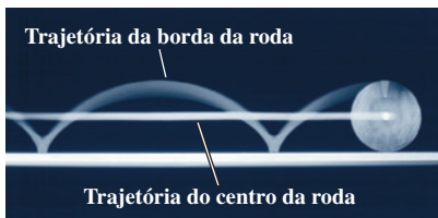
FIGURA 12.42 As trajetórias do centro da roda e de um ponto da borda são vistas em uma fotografia de exposição contínua.
