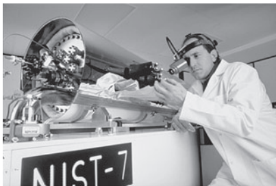
Um relógio atômico do National Institute of Standards and Technology (Instituto Nacional de Medidas e Tecnologia) dos EUA fornece o padrão de tempo primário.
