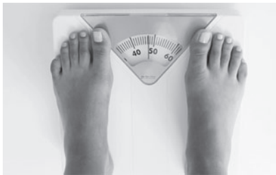
Uma balança de mola, como a familiar balança de banheiro, mede o peso, e não, a massa.
