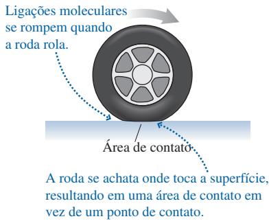
FIGURA 6.14 Atrito de rolamento devido à área de contato entre uma roda e uma superfície.
